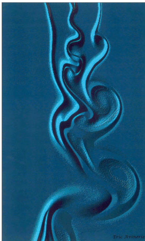
Simulation directe du mélange de 2 jets verticaux à températures différentes
